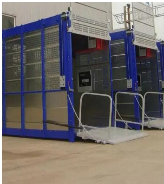
施工电梯扶手式翻板
